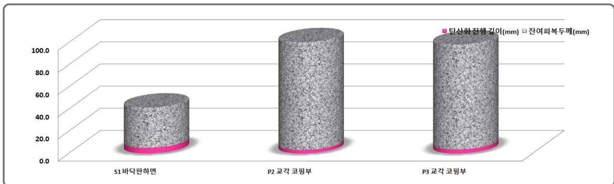
[그림 4.2.3] 탄산화깊이 및 잔여피복두께 측정결과
